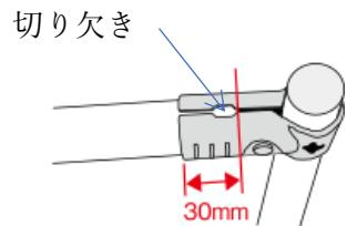
×のように切り欠きから見えるパイプが抜けている場合にはネジを緩めパイプを奥に挿入し、ネジを締め付けてください。
